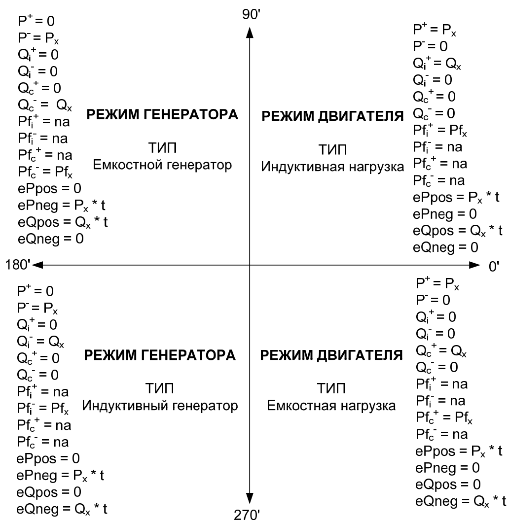
Рисунок 5.10: Диаграмма двигатель – генератор и индуктивная – емкостная фаза – полярность.
